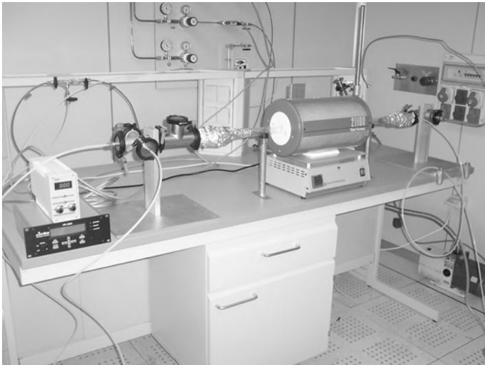
6.14 Thermal CVD apparatus. 64
